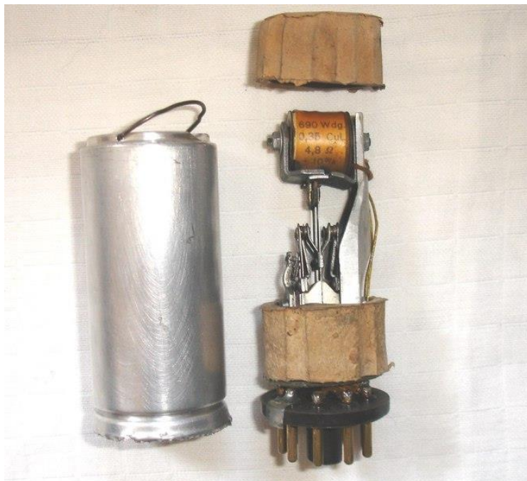
obr. č.1: Tento vynález můžeme označit za prapředka dnešních spínaných zdrojů [7]
